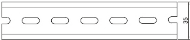
Install rail / 安装轨道: TS35/7.5 or TS35/15
